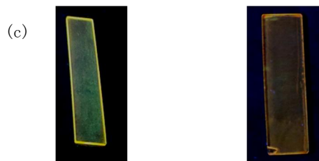
ポリマー1, 2 の溶液中での (a) 吸収, (b) 発光スペクトルと (c) ポリマーフィルムの発光の写真 (石英基板, 365 nm の紫外光で励起) (左) 1, (右) 2
